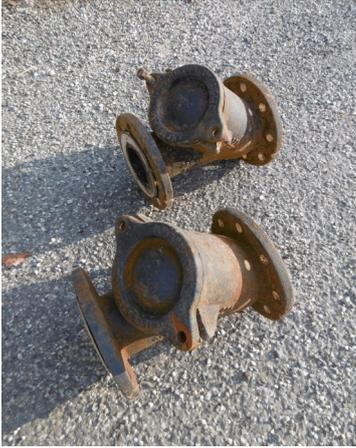
**Août: Remplacement de 2 clapets anti-retour dans le puits d'assainissement « Le Patis » par Pascal et Pierre.**
